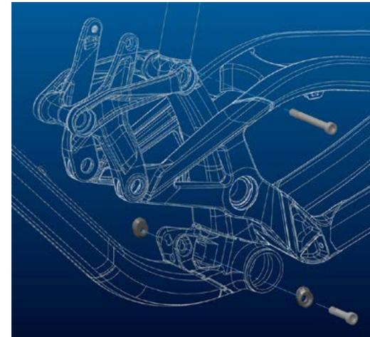
Am Gambler können Sie die Tretlagerhöhe über dem Boden um 10mm in 2 Positionen verstellen durch das Drehen eines Geo-Chips.
