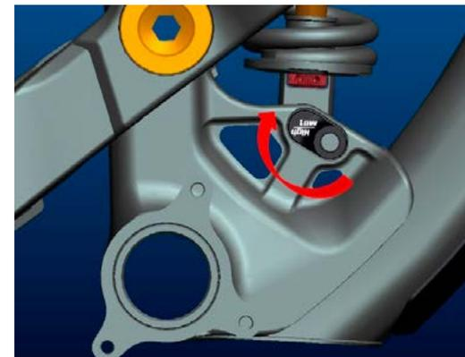
Um die Einstellung zu verändern, lösen Sie bitte, wie folgend dargestellt, den Dämpferbolzen mit einem 6mm Inbusschlüssel.
