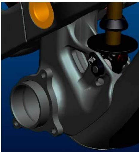
Am Gambler 700 ist das Tretlager BB PF 104 mit einer Gehäusebreite von 104mm und einem Innendurchmesser von 41mm für PressFit Kugellager.
