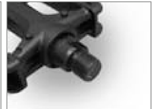
Achse mit Gewinde des linken Pedals
