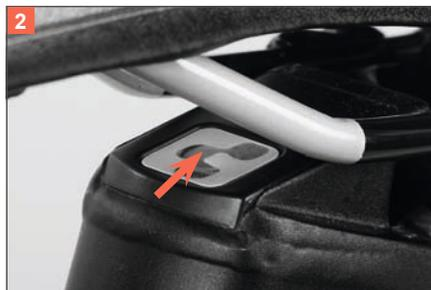
Die Batterie kann über die Ladebuchse auch geladen werden, während sie im CUBE Pedelec/E-Bike montiert ist (3).
