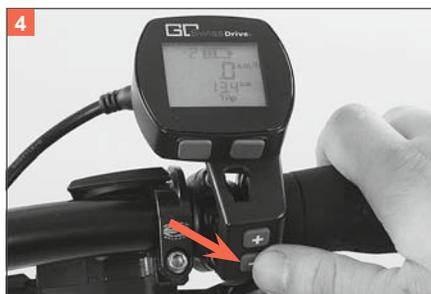
Das Antriebssystem bietet fünf Fahrstufen und drei Rekuperationsstufen (Rückespeisung gewonnener Energie in die Batterie und Motorbremse).
