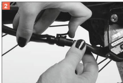
7. Lösen Sie die Drehmomentstütze vom Rahmen, indem Sie die Schraubenklemmung der Drehmomentstütze am Rahmen entfernen.
