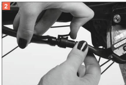
3. Kontrollieren Sie am Display des Bedienelementes, ob das System abgeschaltet ist **(1)**. Verbinden Sie erst dann den Motor mit dem Kabelbaum. Stecken Sie dafür den Motorstecker in das Gegenstück am Kabelbaum **(2)**. Achten Sie auf den Verpolschutz (geometrische Ausrichtung) am Stecker. Stecken Sie die Stecker langsam und gefühlvoll und keinesfalls mit Gewalt ineinander.
